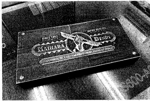
木材をインディゴ染めし、レーザー加工で柄を出す
